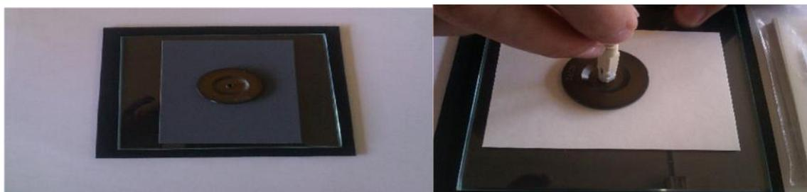
Cuando entiendas, de acuerdo al procedimiento 16, que el pulido está terminado, límpialo con alcohol isopropílico y colócale el tapón protector. Recuerda que un exceso de pulido puede deteriorar el conector.
