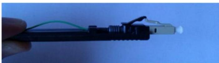
Manteniendo el cable, empuja con la otra mano el conector hacia la unión. En ese momento la fibra romperá un gel adaptador de índice que existe en el interior de conector y quedará sujeta.
