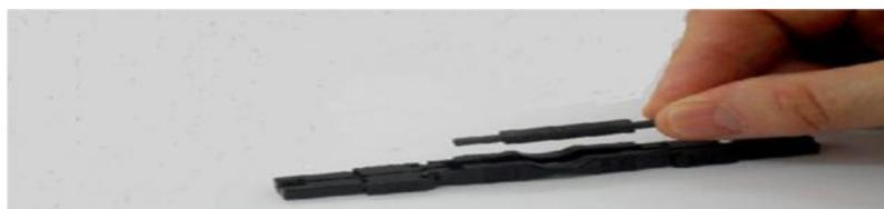
El soporte permite el alineamiento y sujeción de las fibras, y la parte central, es un tubo donde se introducen los dos extremos a unir y contiene un adhesivo adaptador de índice que fija dichos extremos de las fibras.
