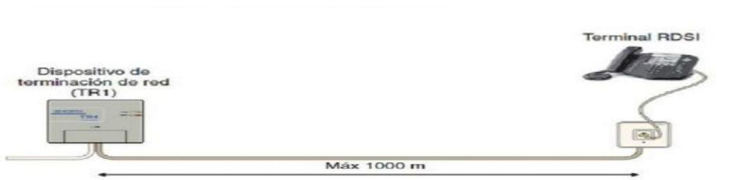
FIG. CABLEADO PUNTO A PUNTO
